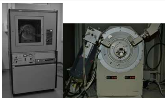
Fig. 5.- Difractómetro marca Siemens, modelo D-550 con el que se realizó el experimento. Tubo con anticátodo de Cu, monocromado de cristal curvo de grafito. Radiación empleada: K.
