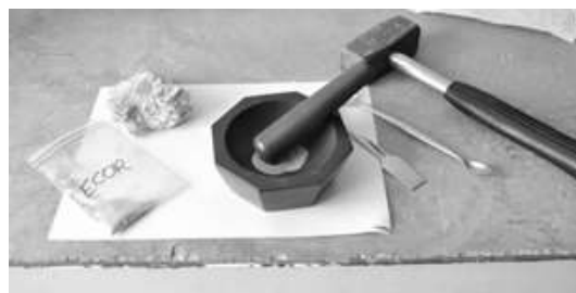
Fig. 6.- Preparación de la muestra ECOR con la maza y el mortero manual de ágata.
